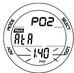
Fig. 46 - SET PO2 ALARM
