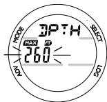
Fig. 42 - SET DEPTH ALARM
